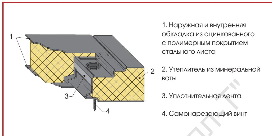
Схема крепления стеновых панелей к несущей конструкции
