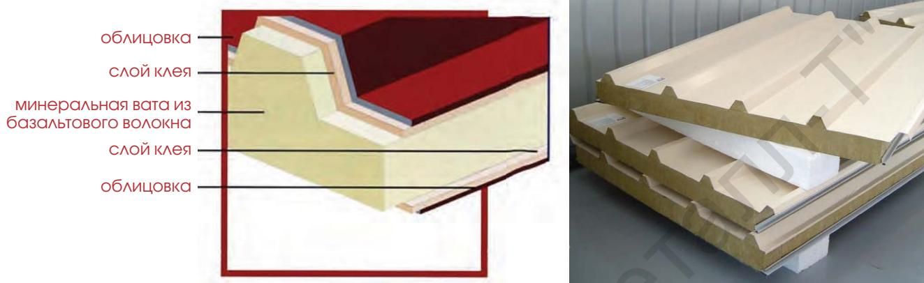
Трехслойные металлические панели типа «сэндвич» отличаются высокими водоотталкивающими свойствами. Общее содержание влаги, конденсируемой из воздуха во внутреннем объеме утеплителя, не превышает 1% при относительной влажности воздуха 95%. Это обеспечивает стабильно высокие теплозащитные свойства панелей при различных погодно-климатических условиях.
